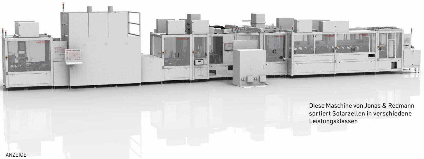
Diese Maschine von Jonas & Redmann sortiert Solarzellen in verschiedene Leistungsklassen
